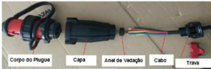
Passe o cabo através do anel de vedação e da capa do plugue, conecte os fios aos terminais e prenda a capa de cobertura ao cabo da braçadeira.
