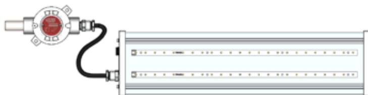
Para alimentação sem a utilização de uma caixa de ligação Ex, utilizando um cabo de 3 vias sem emendas, abrir a tampa lateral e fazer a conexão dos cabos no conector, conforme orientações do manual de instalação.
