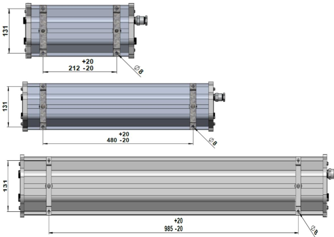
Fixe os perfis de suporte da luminária na parede, teto ou estrutura metálica, utilizando parafusos e arruelas lisa e de pressão conforme diâmetro do furo.
